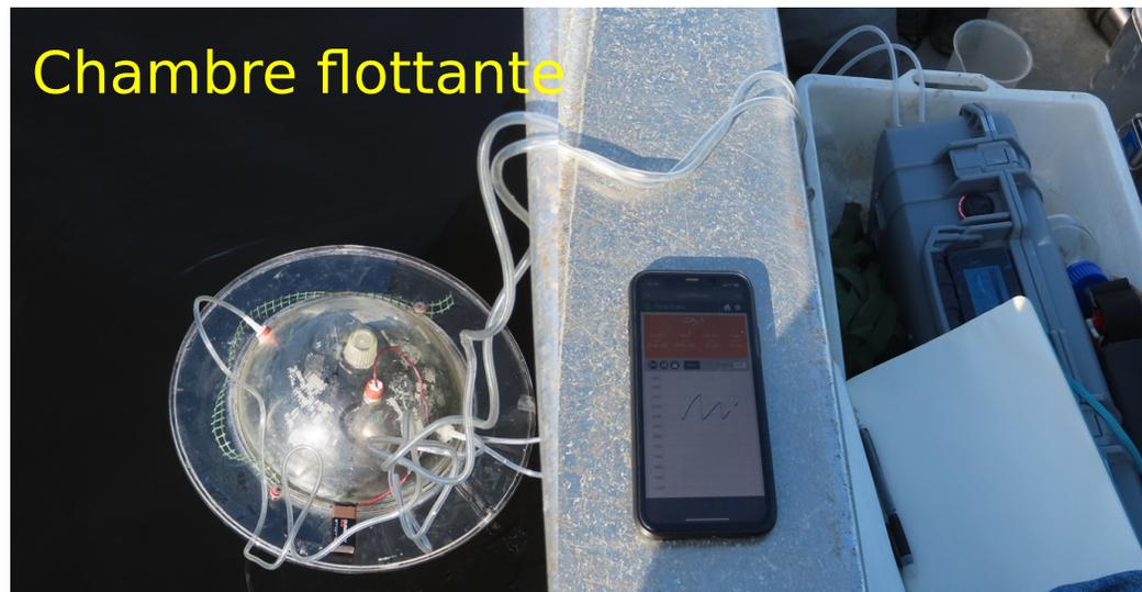
Méthode headspace pour la mesure des concentrations des gaz
