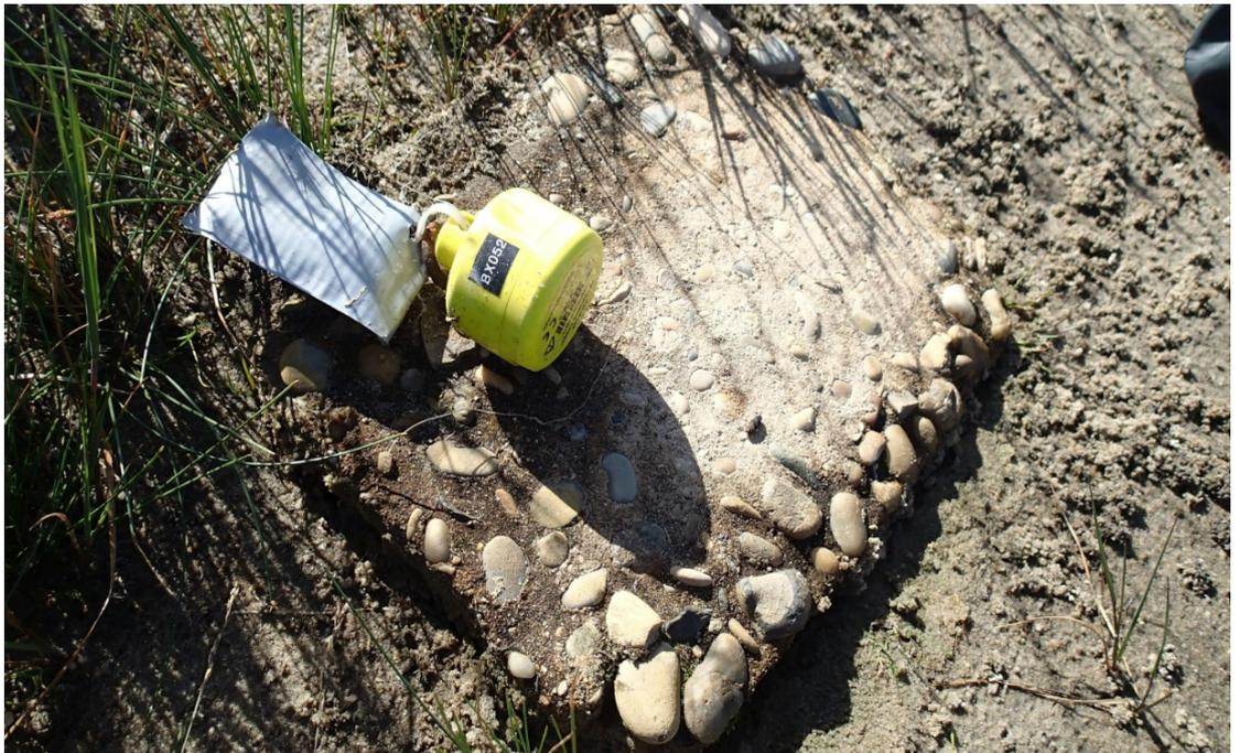
Figure 4 : sonde de mesure de la température : tinytags
